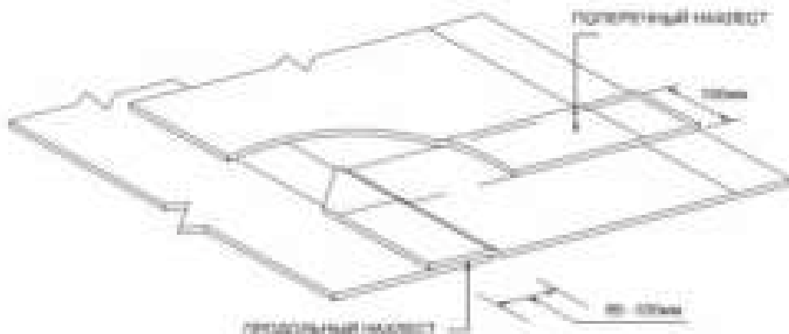
Рисунок 8.3 – Поперечные и продольные нахлесты полотен
