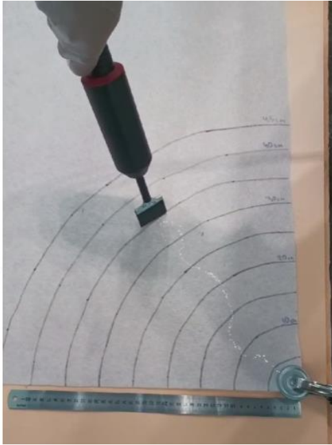
Рисунок 3. Искрение по воздуху (формирование дуги или дуг) НЕ допускается
